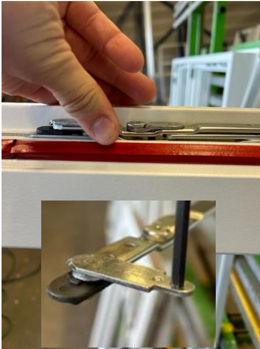
33. Het haaks omgezette palletje evenwijdig met de schaar positioneren
